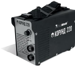
Сварочные инверторы серии «Корунд» предназначены для ручной дуговой сварки штучным покрытым электродом на постоянном токе. Аппараты выполнены по новейшей IGBT технологии, позволяющей добиться минимального веса и габаритов. Инверторы данной серии позволяют получать сварные швы высокого качества и отличаются малым разбрызгиванием металла. Аппарат имеет ряд встроенных функций, позволяющих оптимизировать и облегчить процесс сварки, таких, как: Hot – Start, Arc-Force и Anti-Sticking.
